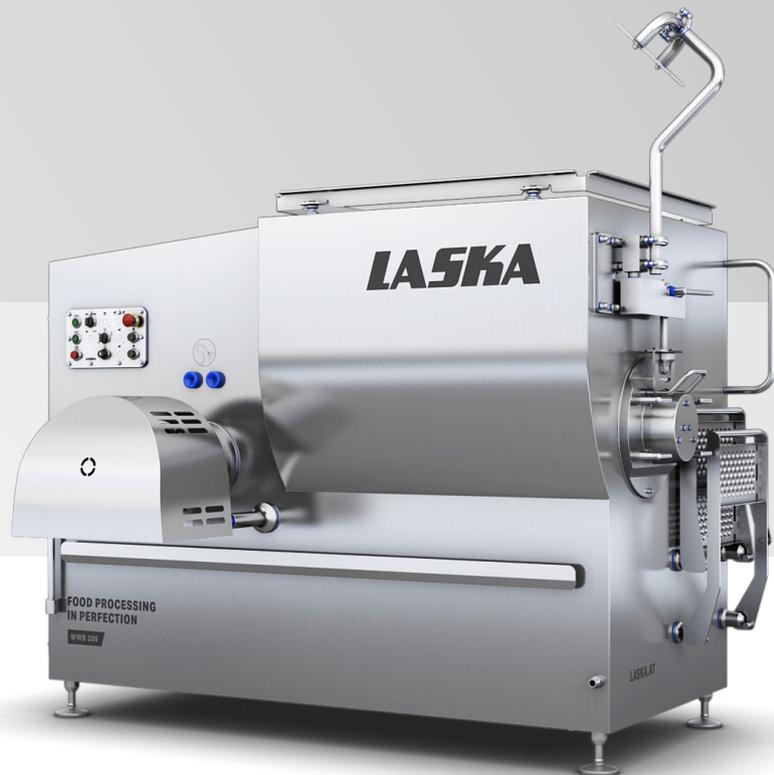
Die Firma LASKA bietet leistungsstarke Wölfe zum Wolfen von Käseabschnitten für die anschließende Weiterverarbeitung sowie Mischmaschinen für Frischkäsemassen, Fonduemischungen und Schmelzkäsezubereitungen.
