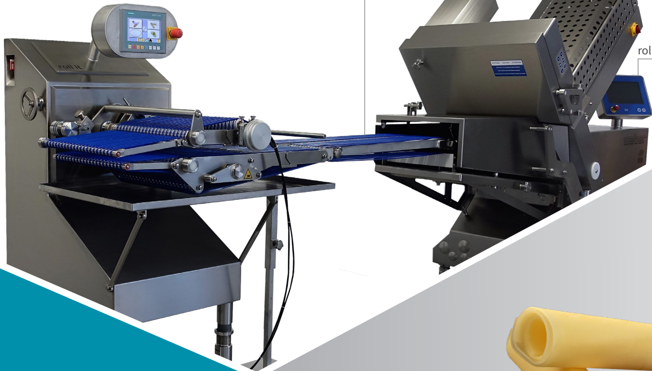
Rundriemenband mit Spureinstellmöglichkeit Spring-belt conveyor with adjustable track control
