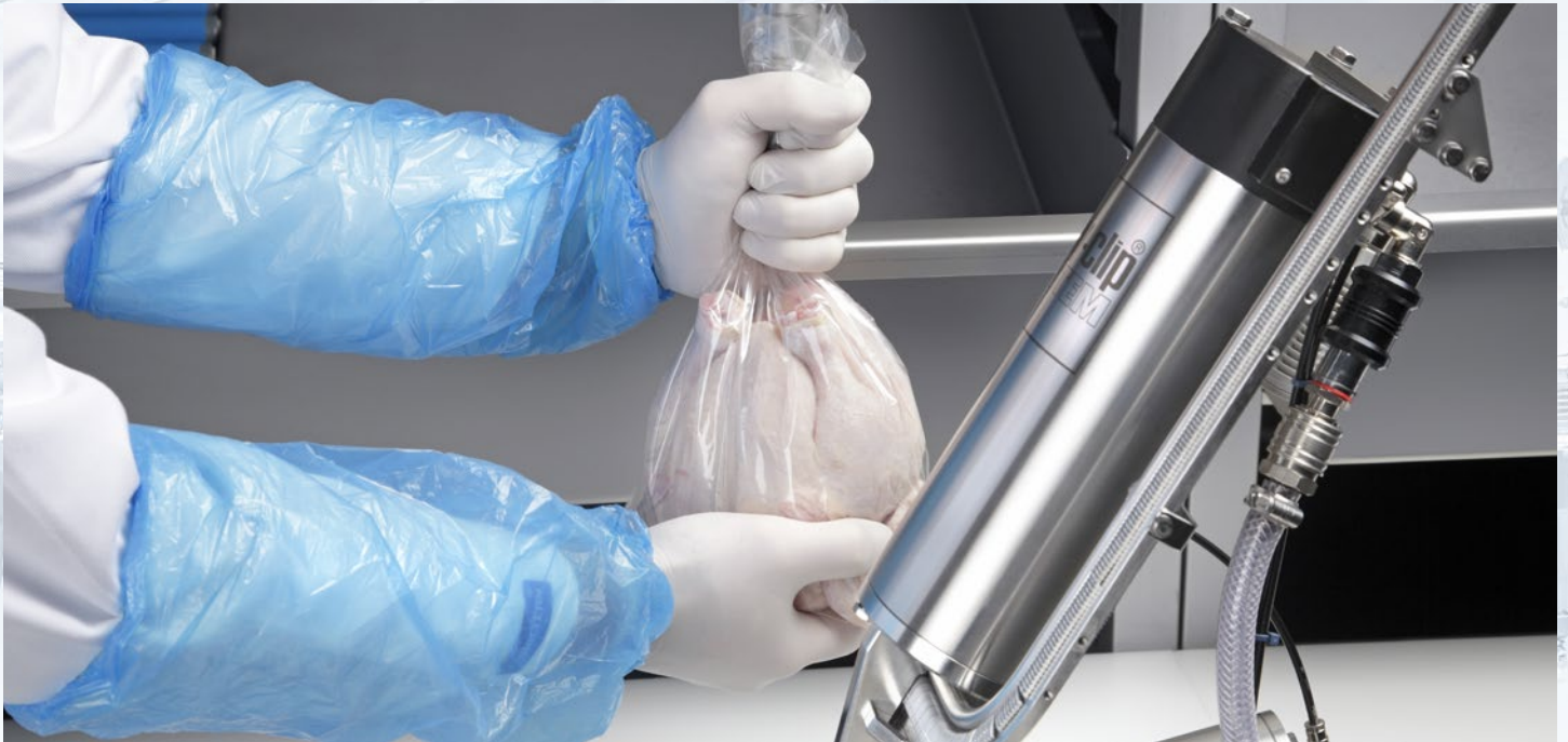
Vertikale Vakuumdüse (Zugüse) im Einsatz mit der Clipmaschine EZ600 der Easy Clip Line
