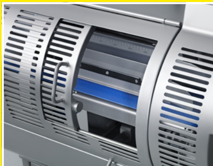
Überspreizung für luftfreie Lockerfüllung von Formprodukten
