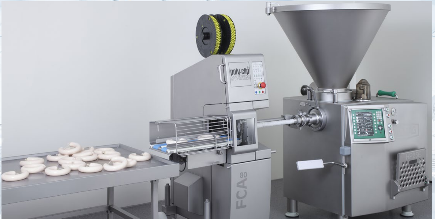
FCA 80 – mit angepasster Frontklappe und Doppelförderband speziell für Ringe
