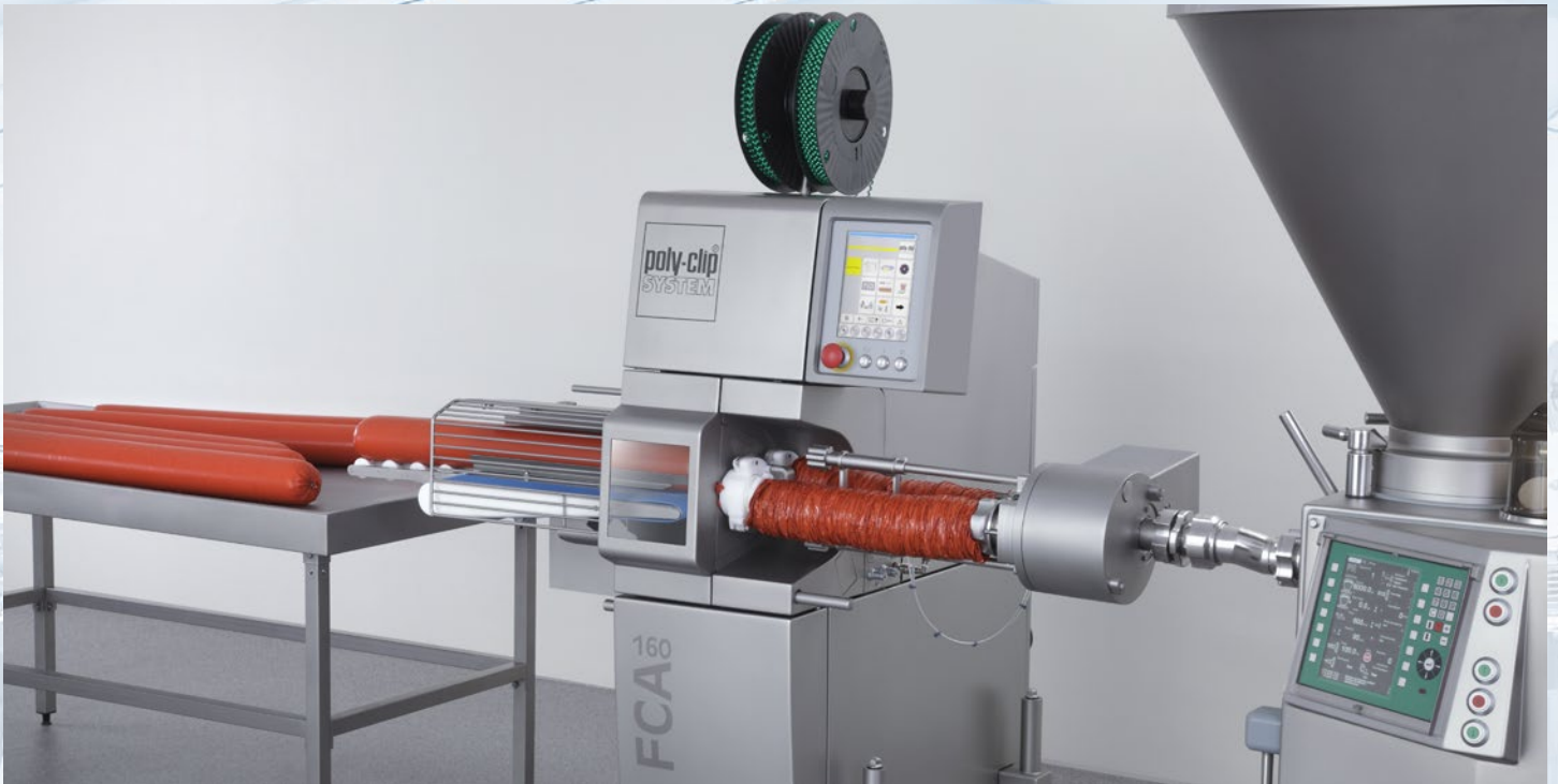
Die FCA-Reihe mit glatten Flächen aus Edelstahl für leichte Reinigung
