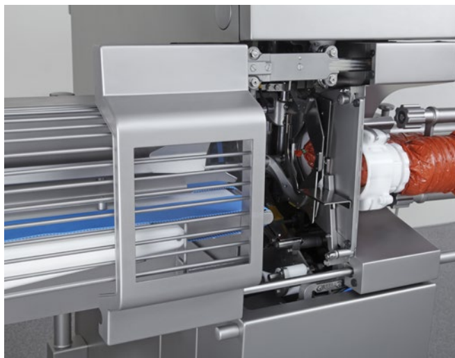
Kürzeste Rüstzeit durch Komfortöffnung der Frontklappe
