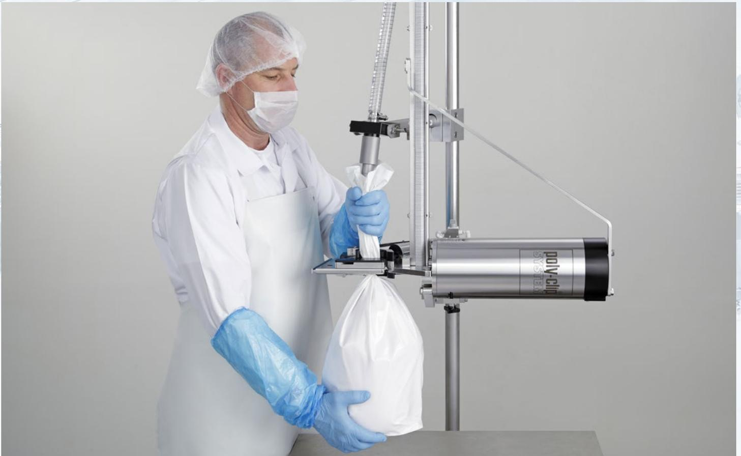
EZ 800 Horizontalversion mit Montagehalterung und vertikaler Vakuumdüse für schwere, unhandliche Produkte
