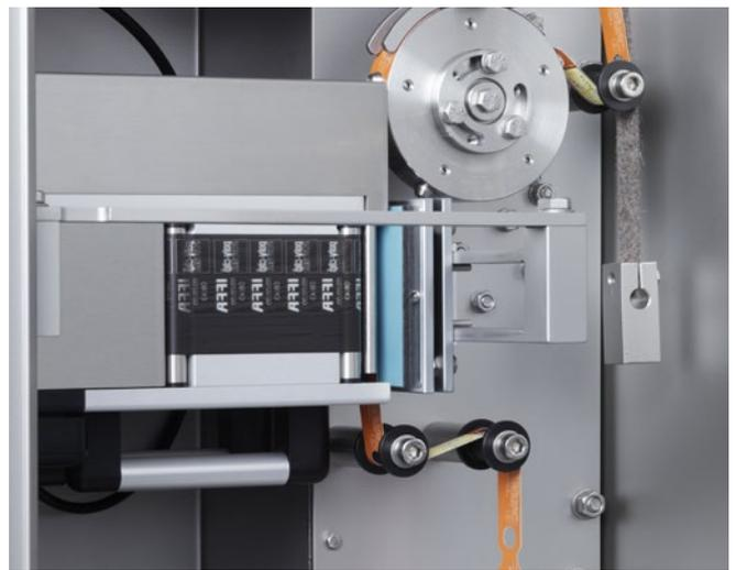
Transport über Tänzerwalzensystem für einen positionsgenauen Druck
