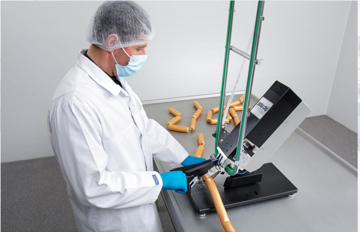
Verschließt sicher Saitlinge, Schweine-, Rinderkranz- und Kunststoffdärme bis Kaliber 60 mm
