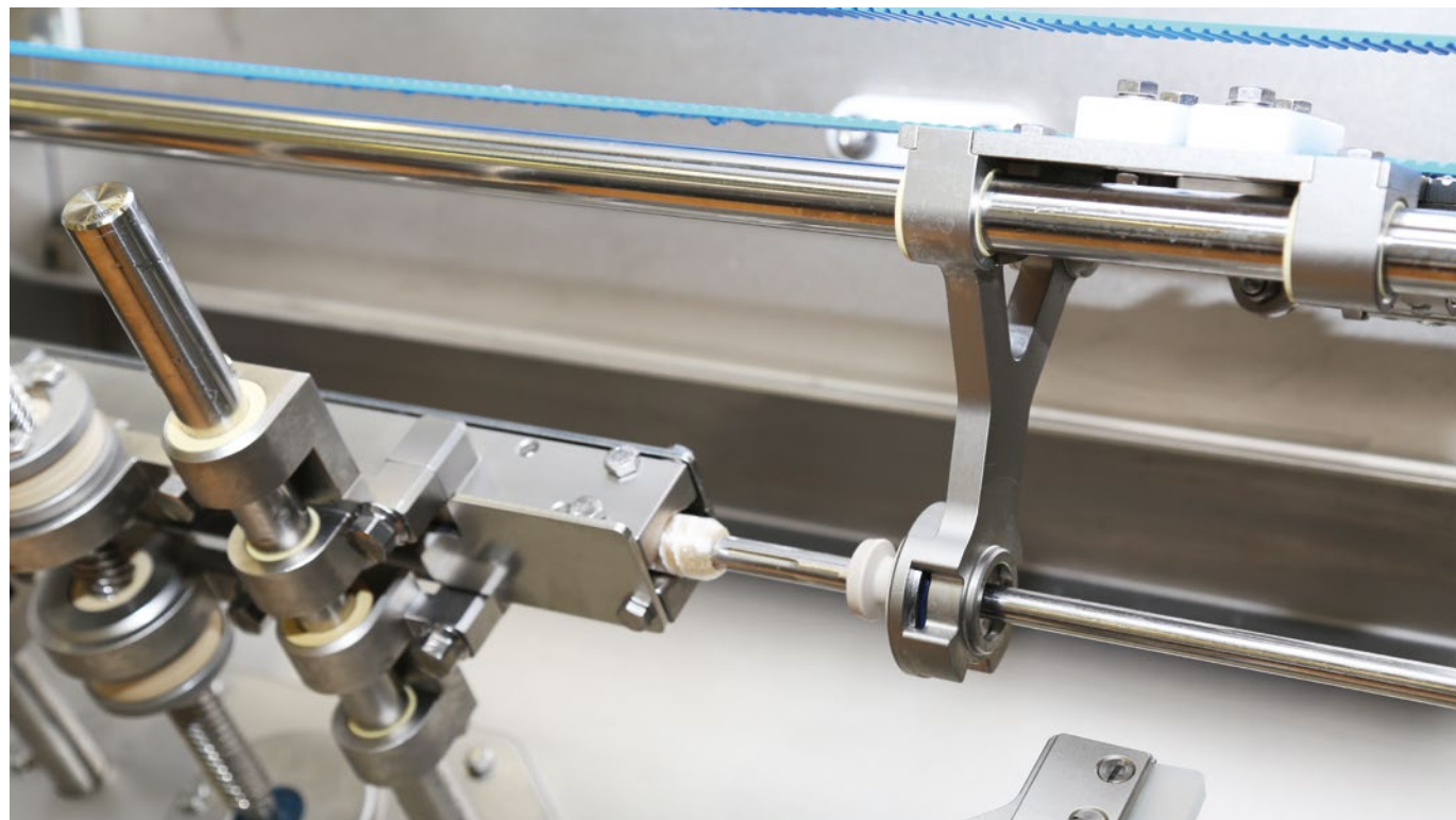
Das VEMAG Greifer-Prinzip für eine Stabilisierung während des Darmaufziehens
