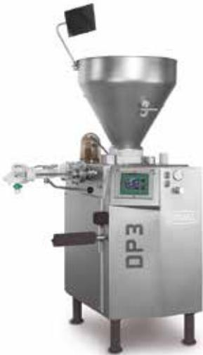
Die platzsparende DP3 ist eine zuverlässige und robuste Vakuumfüllmaschine mit Drehschieberpumpentechnologie, die speziell für die Anforderungen des Handwerks entwickelt wurde. Sie ist vielseitig einsetzbar und eignet sich ideal für die kleinen bis mittleren Betriebe aus dem Fleischerhandwerk.
