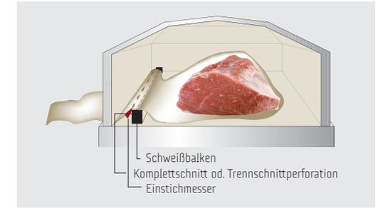
Die **Doppel-Biaktiv-Hochdruckschweißung** sowie die **federgespannten Heizbänder** sind Teil der Standardausstattung und garantieren sichere und zuverlässige Schweißnähte trotz Falten, Fett und Feuchtigkeit im Nahtbereich. Spannfedern halten die Heizbänder auch bei Dauerbetrieb in der richtigen Spur.
