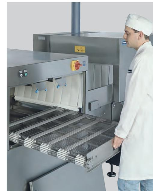
Einfache und schnelle Reinigung – das komplette Transportband ist mit wenigen Handgriffen aus dem BL15 herauszuziehen – Abtropfwanne und der Maschineninnenraum sind frei zugänglich.
