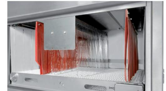
Zwei Wasservorhänge von oben, Wasserschwall von unten und seitliche Düsen.
