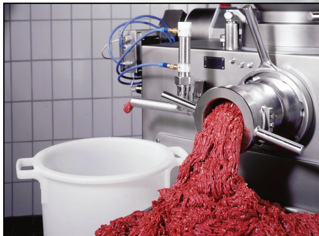
Trennwolf 982 mit automatischem Trennventil
