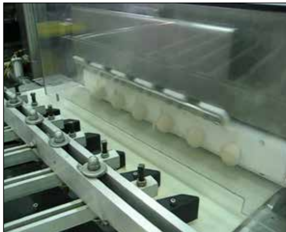
Mehrbahnige Servoabschneidevorrichtung für Hamburgerbrötchen
