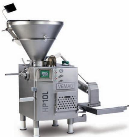
Die HP10L ist der Abdrehspezialist mit Förderkurve für den flexiblen Einsatz. Die Lösung für alle Füllaufgaben in der Würstchenproduktion ohne Füllwolf. Ihr Können kommt besonders mit Darmhaltevorrichtungen oder den VEMAG Flexible Sausage Lines zum Vorschein. So ist das Abdrehen und Portionieren auch weicher Massen ein Kinderspiel.
