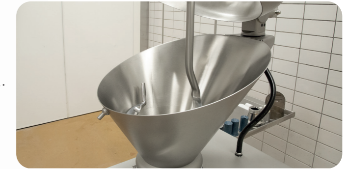
Trichter und Förderwerk
