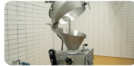
Trichter und Förderwerk
