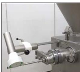
Nutzung mit Füllrohren an Füllwolf 980 oder Trennwolf 982
