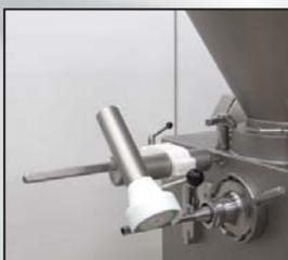
Nutzung mit Abdrehrohren (Länge 271 mm oder 371 mm)
