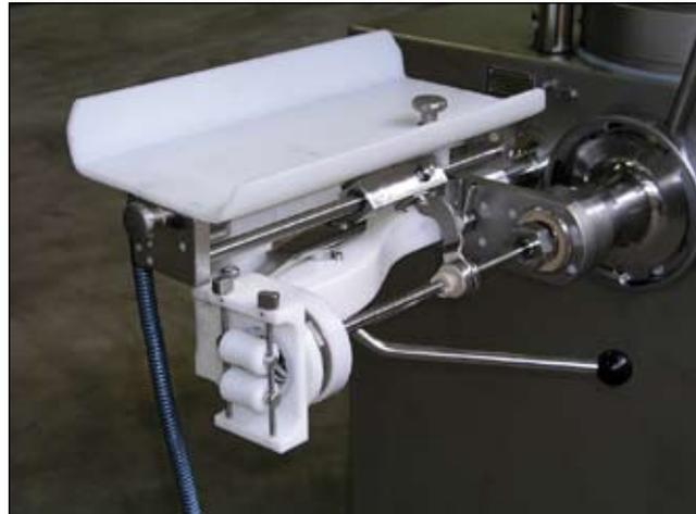
DHV 810 mit VEMAG High-Speed-Abdrehgetriebe
