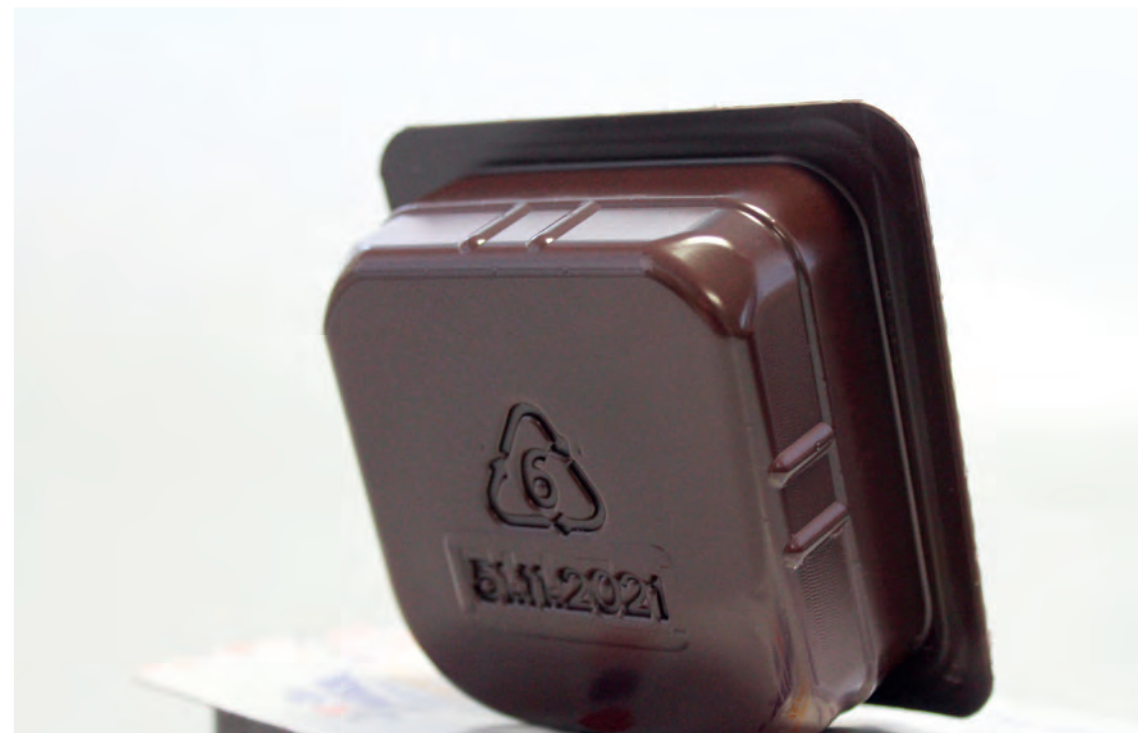
Formung mit Vorheizung und Stempel
