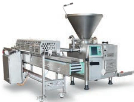
Der Walzenfüllkopf 863 portioniert sauber und mit höchster Gewichtsgenauigkeit Roggen-, Vollkorn- und glutenfreie Teige sowie andere Massen direkt in Backformen. Er ist optimal geeignet für die vollautomatische industrielle oder mit Sicherheitstisch ausgerüstet für die handwerkliche Portionierung von Stück- und Stangenbrot. Der Walzenfüllkopf 863 erreicht eine Ausstoßleistung bis zu 50 Portionen pro Minute für eine äußerst effiziente Produktion.
