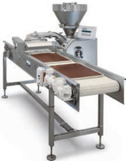
Der Platten- und Bahnausformer wird überall dort eingesetzt, wo weiche Teige und Massen mit hoher Gewichtsgenauigkeit abgeteilt und direkt auf Bleche oder plattenförmige Produkte positioniert werden, wie für Blechkuchen, Toppings, Füllungen oder Brownies. Der Platten- und Bahnausformer ist mit einem pneumatisch betätigten Walzenverschluss ausgerüstet und kann an die spezifischen Anforderungen, wie z.B. unterschiedliche Blechgrößen, angepasst werden.
